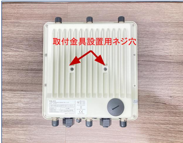
1) 取付アタッチメントを使い、付属の金具をPCWL-0410のボトムパネルに取り付ける
