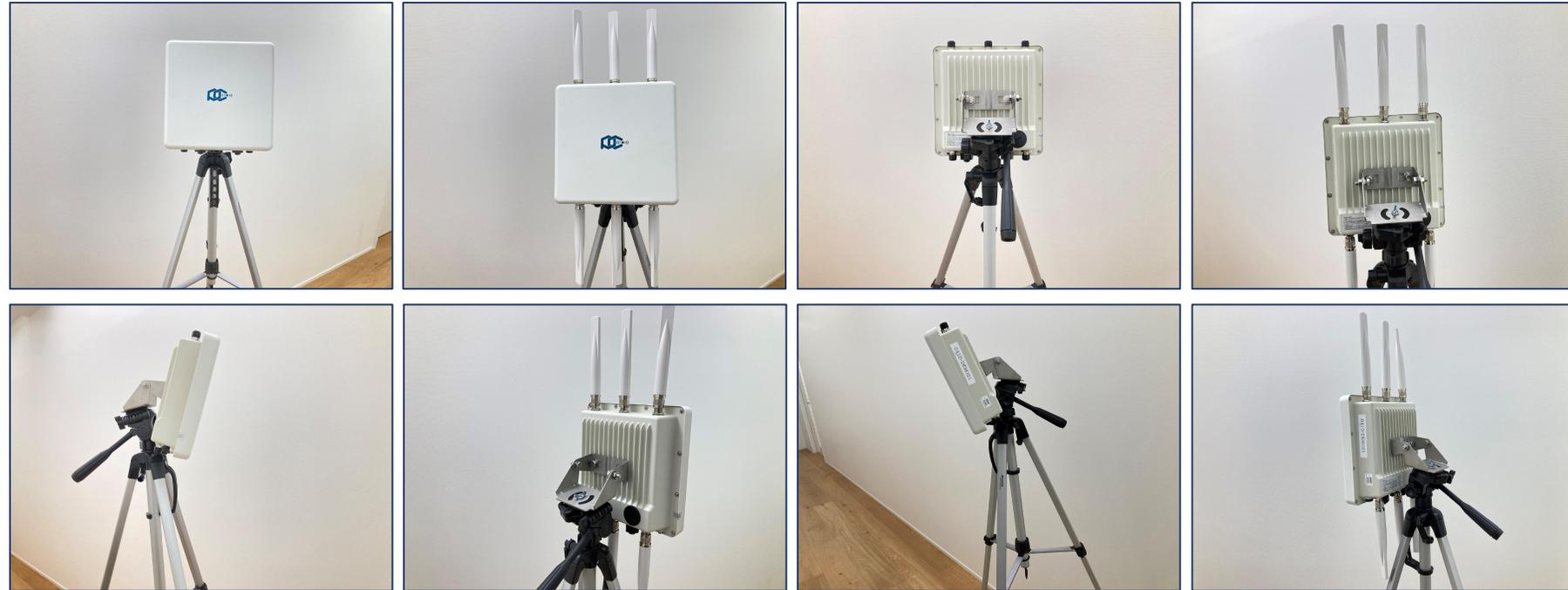
2) 金具を取り付けたPCWL-0410を三脚につけ、金具と壁をネジで止める
