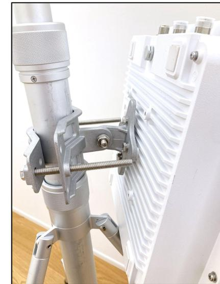
3) その後、M8 x 100 ネジを使用し、ポール・壁用ブラケットと締付金具の間にポールを挟んでしっかりと固定し、取り付け作業はこれで完了です。
