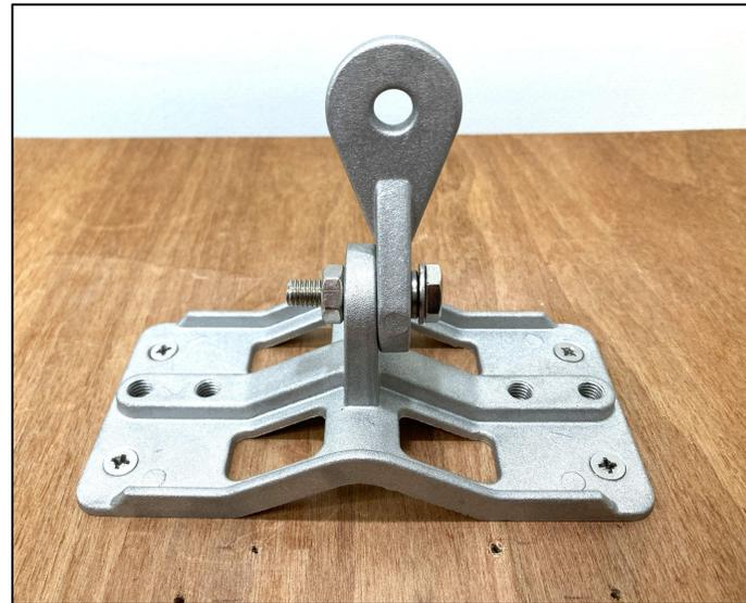
2) 取り付ける場所にポール・壁用ブラケットをアンカーネジで固定し、その後M8 x 35のネジ、ナット、ワッシャ、リングワッシャを使用してアーム金具を固定する。
