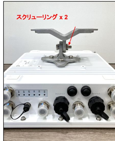
2) M8 x 35のネジ、ナット、ワッシャ、リングワッシャを使用し、まず本体の取付金具基板とポール・壁用ブラケットをしっかりと固定する。
