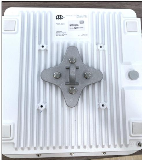
1) 本体の付属の取付金具用ネジ穴に取付金具基板を固定する。
