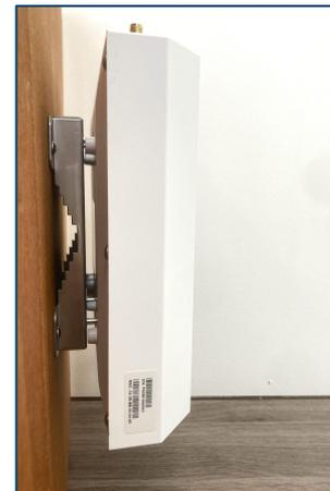
※本体と付属プレートが確実に固定用小ねじによって固定されていることを十分確認してください。
