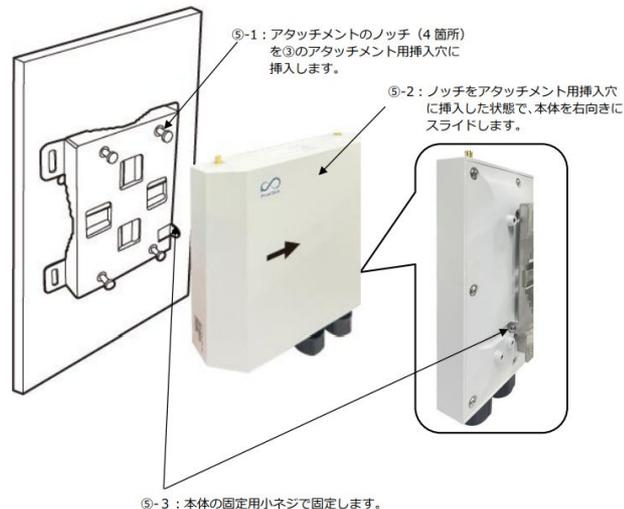
1) 設置する場所に M4ねじを使用し、付属アタッチメントを固定します。
