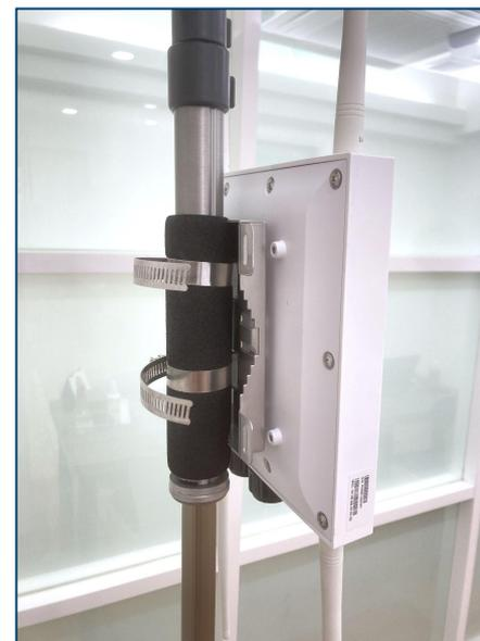
※本体と付属プレートが確実に固定用小ねじによって固定されていることを十分確認してください。
