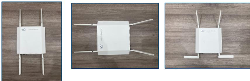
バックホール側とアクセス側の何れのアンテナも対向関係にならない方向で設置。
