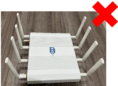
アンテナ 8 本が対向
