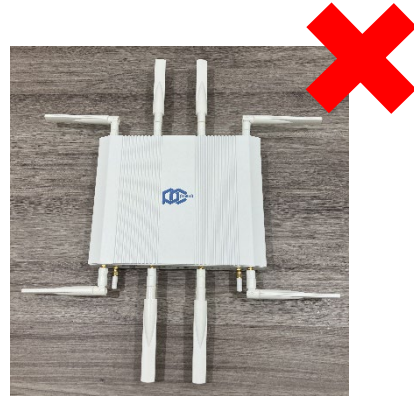
アンテナ 4 本が対向
