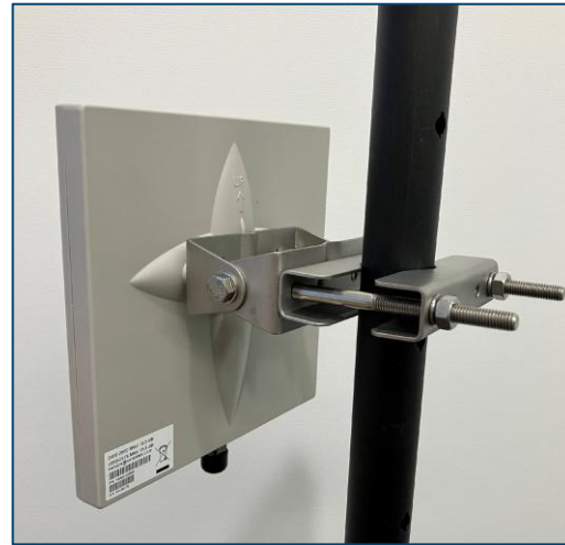
②ポール取り付け用金具（ポール挟み込み用） ポール径：40mm以上63.5mm以下
